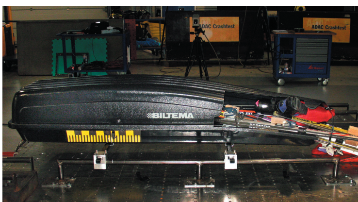
Biltemas takbox gick sönder och innehållet slungades ut vid ett krocktest i 30 kilometer i timmen.
